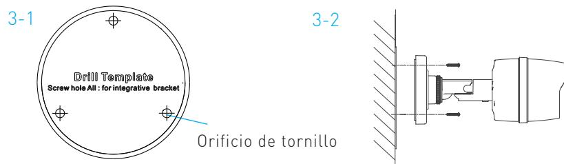
3. Pase los cables de la cámara a través de la base de montaje y conéctelos a través de la apertura lateral.
